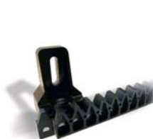
HR050.N Ozubený nylonový hřeben 25 x š.12 mm se spodním úchytem. Viz str. 73
