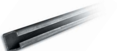
CP444 Válcovaný nosný „C“ profil 50(š)×55(v) mm se stěnou o síle 4 mm pro samonosné brány. Viz str. 174
