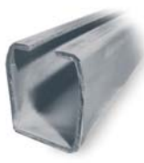
CP666 Válcovaný nosný „C“ profil s povrchovou úpravou galvanickým zinkem 90(š) x 110(v) mm se stěnou o síle 6,5 mm pro samonosné brány. Viz str. 184
