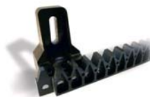
HR050.N Ozubený nylonový hřeben 25x š.12 mm se spodním úchytem. Viz str. 73
