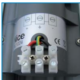
Svorkovnice pro napájení uvnitř druhého pohonu
