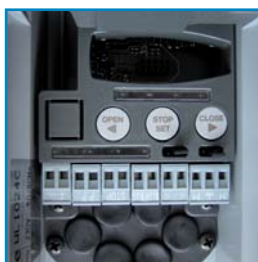
Zabudovaná řídicí jednotka s SM slotem
