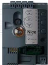
SNA20 Náhradní řídicí jednotka pro SPIN23KCE.
