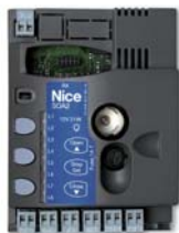
SOA2 Náhradní řídicí jednotka pro SO2000.
