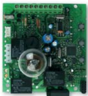
SNA1 Náhradní řídicí jednotka pro SPIN10KCE a SPIN11KCE
