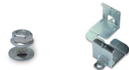
VR SPA82 Šroub vratový M8x16, 2 mm se čtyřhranem pro pohodlnou montáž úhelníku SPA80, zinkován.
