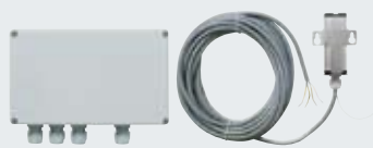
Dvoukanálový reléový přijímač HER 2 Se 2 bezpotenciálovými reléovými výstupy, frekvence 868 MHz, IP 65, napájecí napětí 24 V DC/230-240 V AC, samostatná anténa pro venkovní použití (IP 65), v hliníkové skříni bezpečné proti sabotáži, s přípojovacím vedením o délce 7 m, tří vodičovým, vyhodnocovací jednotka pro vnitřní prostor
