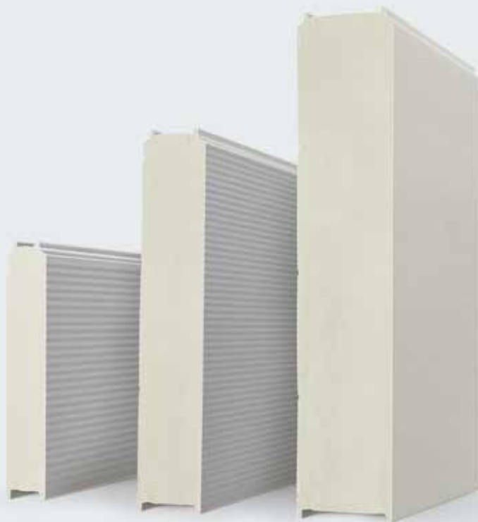
Dvoustěnné ocelové sandwichové lamely s přerušným tepelným mostem ve třech tloušťkách 42, 67 a 100 mm
