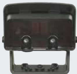
Radarový detektor pohybu MWD Rychlé a cílené automatické otvírání vrat, rozpoznání směru, max. montážní výška 7 m, montáž v chladicím prostoru možná do maximálně -22°C, Krytí třída ochrany IP 65
