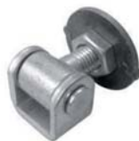
PAVM* Závěsný nastavitelný zinkovaný pant s uzavřenou konzolou pro přivaření ke křídlu brány a s maticí k přivaření na tělo sloupku. KS./BALENÍ 1
